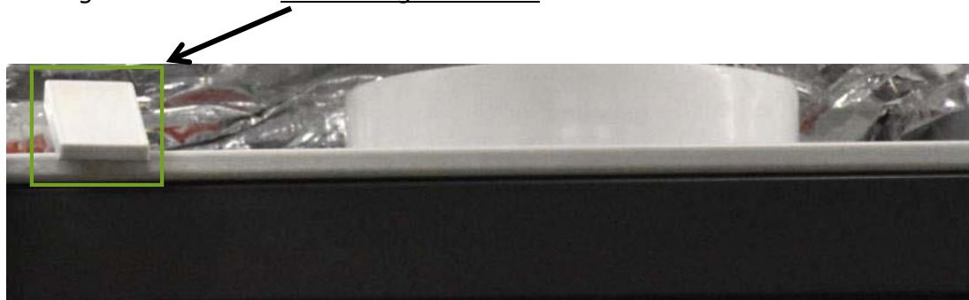
**Das Gerät mit geöffneter rechter Seite sieht so aus. Den Reset-Button sehen Sie unten angezeichnet**
